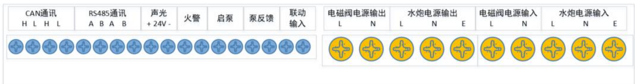
图 4-2 现场控制箱接线端子
