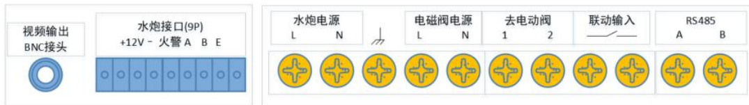
图 3-2 TZ-JKP02 型电源接线盒端子定义
