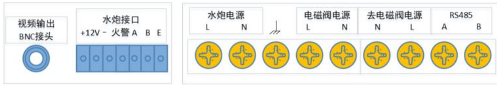
图 3-1 TZ-JKP01 型电源接线盒端子定义
