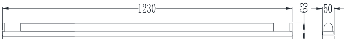
图 4.2 灯具外形尺寸，单位 mm（TS-ZFJC-E18W-6622A）
