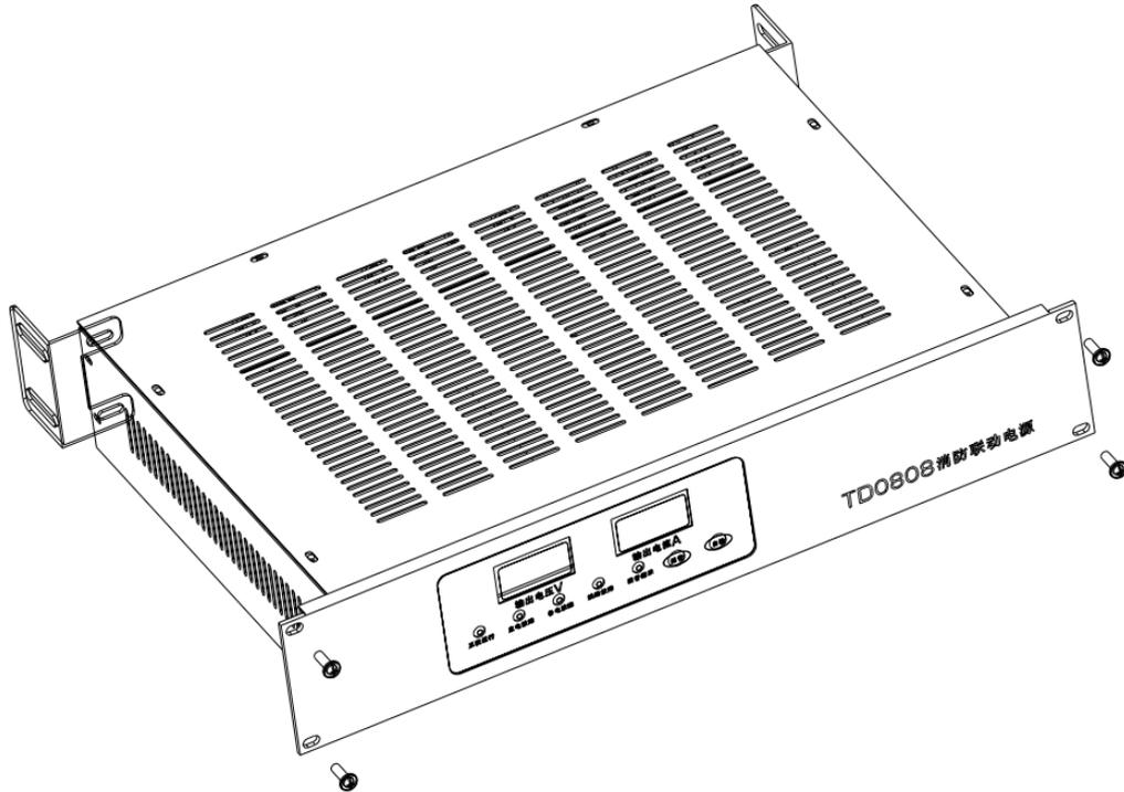
图 6 电源安装示意图
