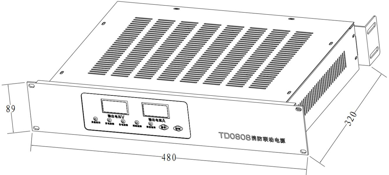
图 1 电源外形尺寸图
