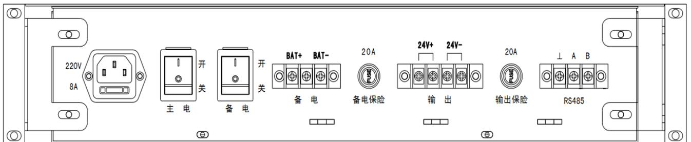
图 5 外接端子示意图
