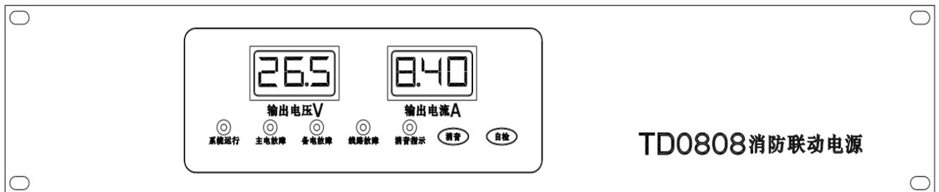
图 2 电源结构面板示意图
