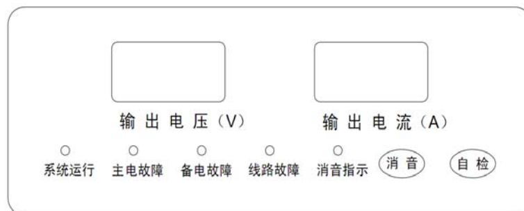
图 2 电源箱面板结构示意图
