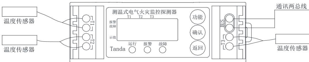
图 2 探测器接线端子
