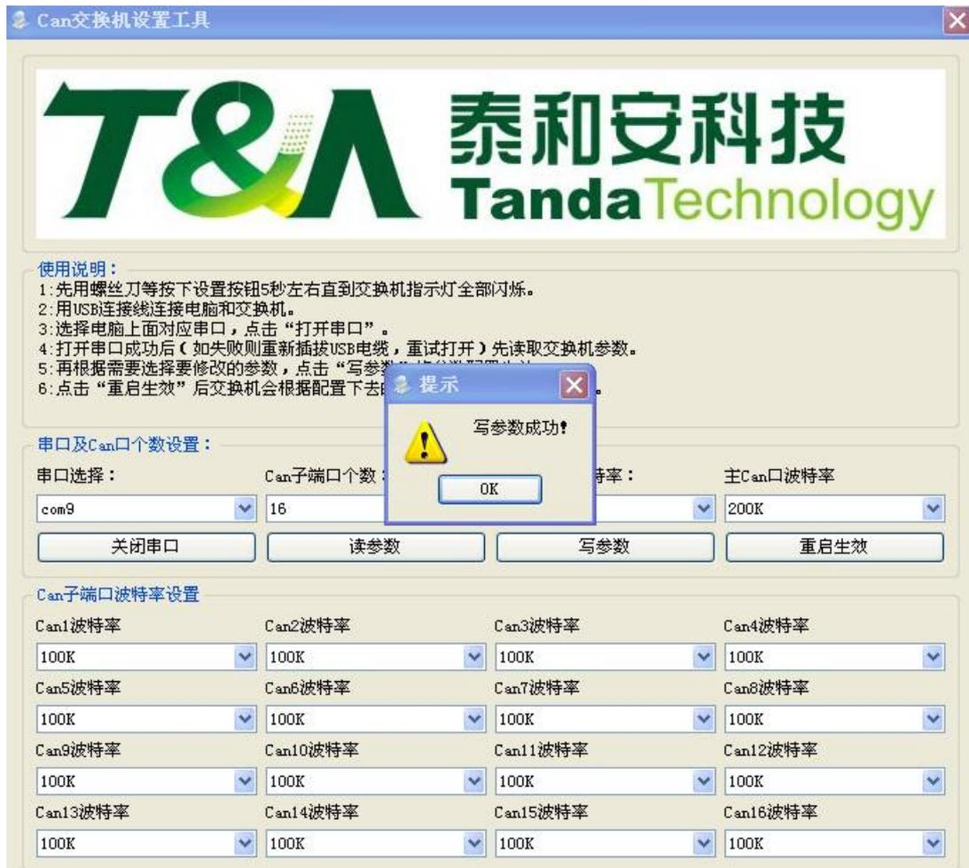
4. 端口波特率为 10K 的时候能够手拉手连接 8 台设备，最后的一台设备要加 120 欧姆的终端电阻，最大连线总长度能达到 3000m，出厂后默认端口波特率都为 10K。
